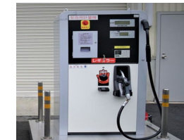
移動式燃料給油機
