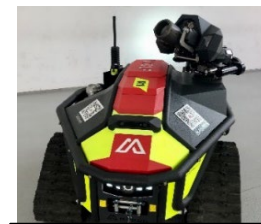
無人走行放水ロボット
