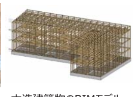
木造建築物のBIMモデル
