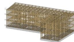
木造建築物のBIMモデル
